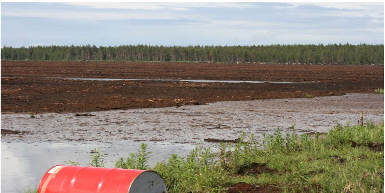
Kuva: Tulviva turvesuo ukkoskuuron jälkeen. Tulvavesiä ei saada kuriin suurten vesimäärien vuoksi, koska esimerkiksi 10 mm:n kuurosade = 10 miljoonaa litraa vettä/km 2 , toisin sanoen 20 mm = 20 l/m 2 .
